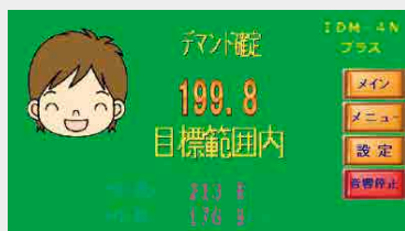
確定電力(正常)
